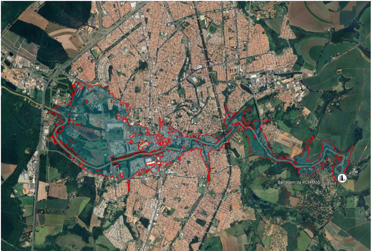
Figura 3 – Zona de Autossalvamento da PCH Mogi Guaçu
