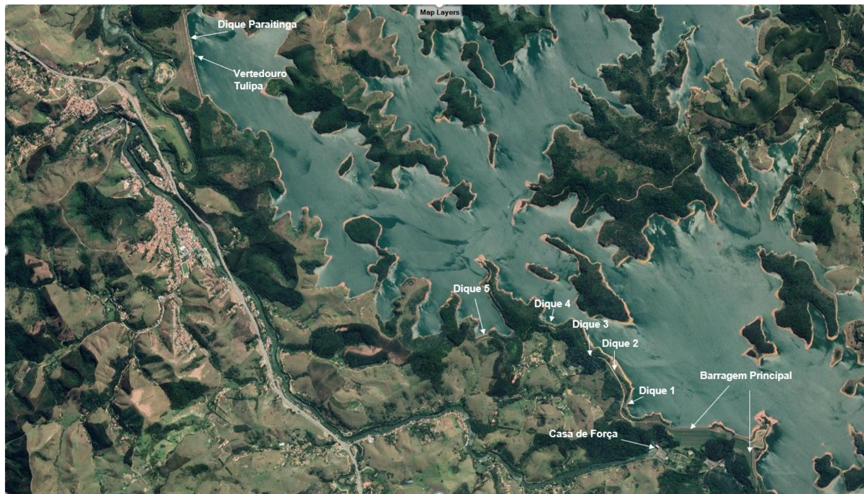
Figura 2 – Arranjo geral esquemático da UHE Paraibuna.
