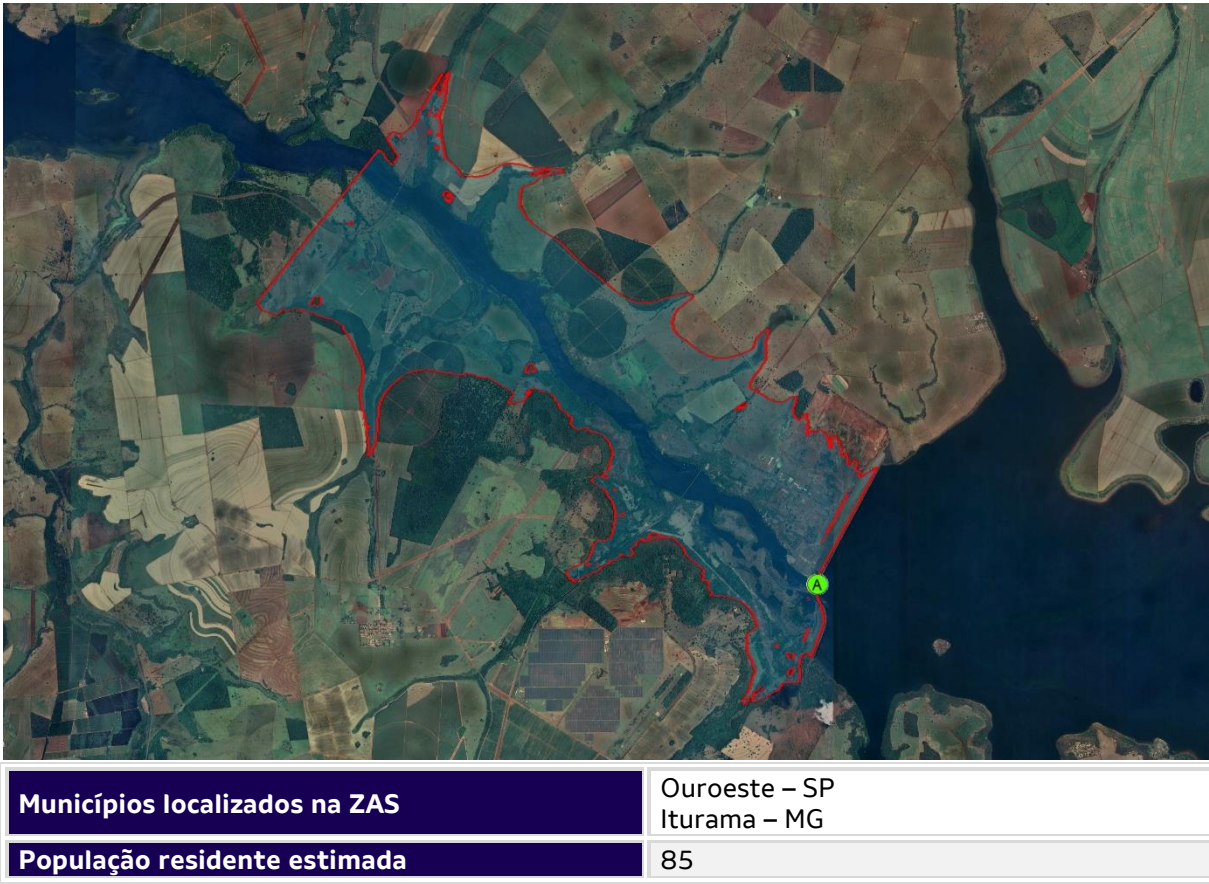
Figura 4 – Zona de Autossalvamento da UHE Água Vermelha
