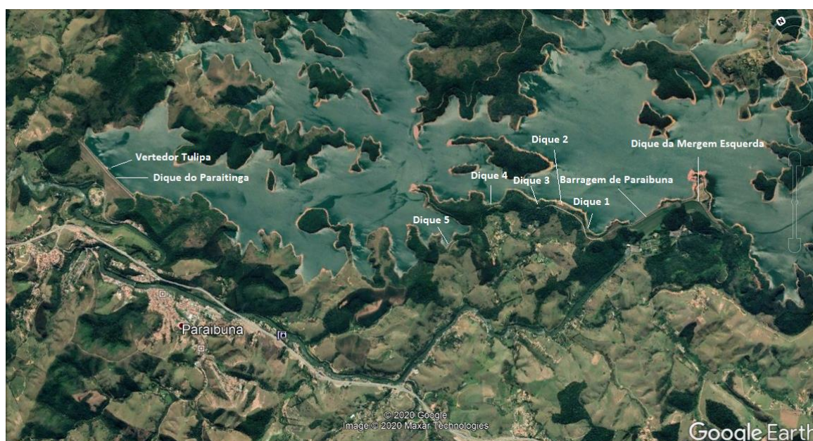
Figura 6 – Arranjo geral da barragem de UHE Paraibuna
